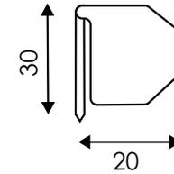
Barra appendi fogli a gravità. Profilo arrotondato in alluminio estruso con tappi di chiusura in ABS e all'interno cilindretti in PVC che permettono un facile inserimento di fogli multipli anche in formati differenti. Completa di biadesivo sul retro.
