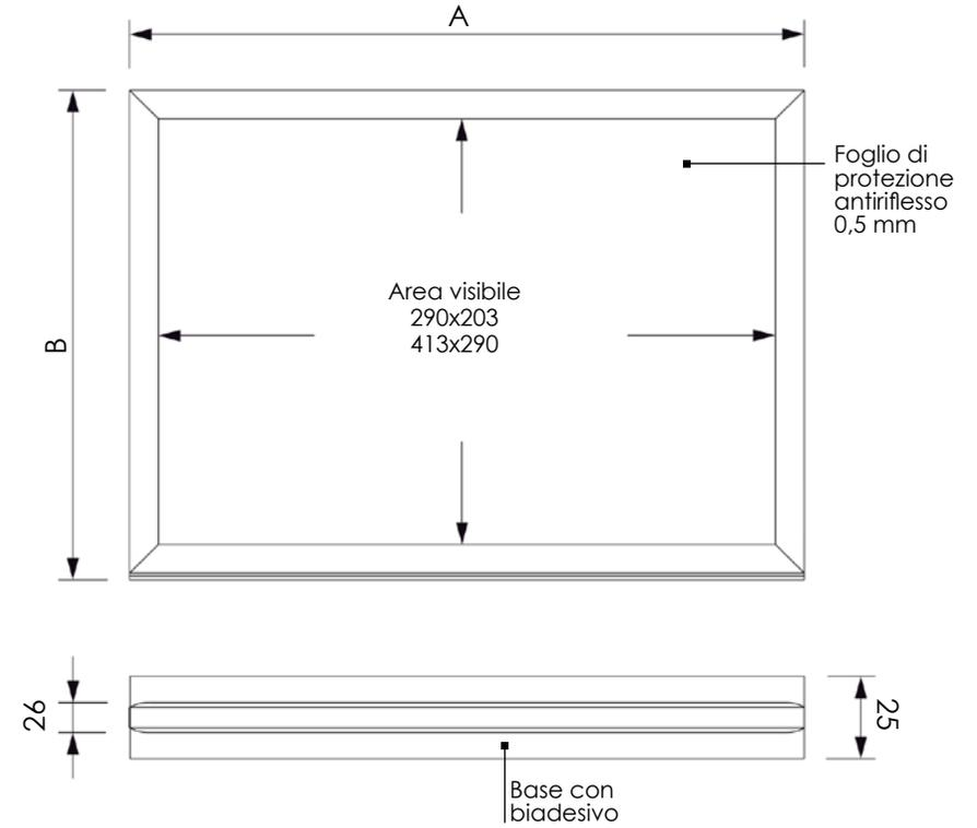
Cornice bifacciale con profili in alluminio anodizzato silver, inserimento delle comunicazioni dal lato tramite la rimozione dell'apposito gommino. Disponibili nei formati A4 e A3 solo orizzontali. Doppio foglio di protezione in PVC antiriflesso e biadesivo per il fissaggio della base incluso.
